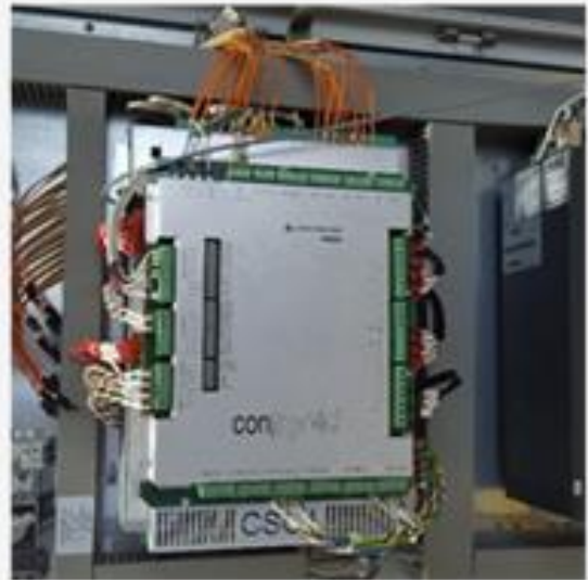
Bild links: Digitales Modell des neuen CSC4-Steuergeräts von Woodward; Bild rechts: CSC4-Windumrichter beim erfolgreichen Feldtest
