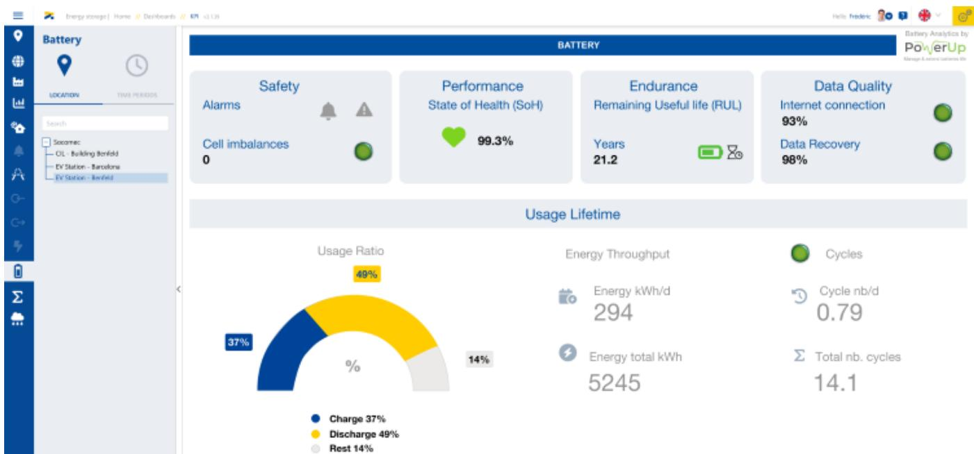
**Bildunterschrift:** SoLive PRO analysiert die Performance und die Lebensdauer und überprüft die Datenqualität.
