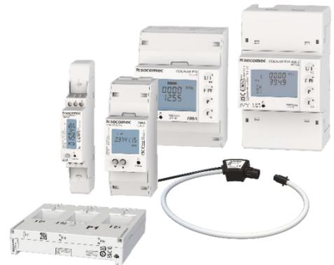
Je nach Modell haben die Zähler einen oder mehrere Impulsausgänge und verfügen über Modbus RTU-, M-Bus- oder Modbus TCP-Kommunikationsanschlüsse. Der Energieverbrauch wird wahlweise in kWh, kVAh oder kVa direkt auf dem hintergrundbeleuchteten LCD-Bildschirm oder über die Überwachungssoftware angezeigt. Alle Varianten eignen sich sowohl für Neuinstallationen als auch zum Nachrüsten.
